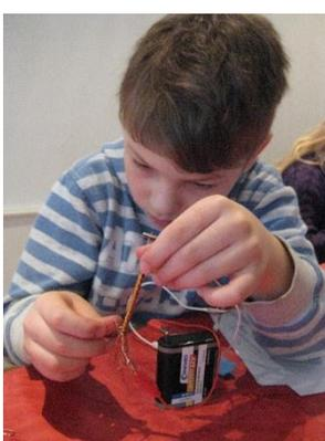
musste man einen Eisennagel mit Kupferdraht umwickeln, die Enden noch ein wenig anschleifen und dann an eine Flachbatterie anschließen. Was denkt ihr ist passiert? Richtig, der Nagel hat wie ein Magnet funktioniert und Schrauben, Büroklammern und vieles mehr angezogen.
